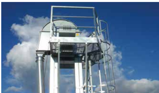
▲ Till fristående skopelevatorer kan serviceplattform vid elevator topp samt steg med ryggskydd levereras.
