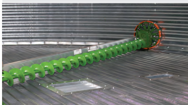
Sveper skruven kan också fås med extra reducerad hastighet av drivhjul med utväxling 16:1 ▼
