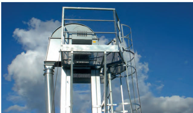
▲ Till fristående skopelevatorer kan serviceplattform vid elevator topp samt steg med ryggsydd levereras.
