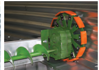
Sveper skruven kan också fås med extra reducerad hastighet av drivhjul med utväxling 16:1 ▼
