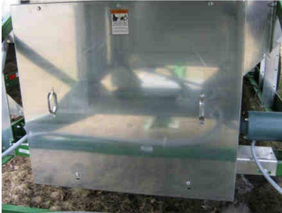
Image 40 – Unload auger/meter roll drive service door
