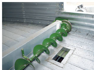
Sukup sveperskruv monterad med standard drivhjul ▼
