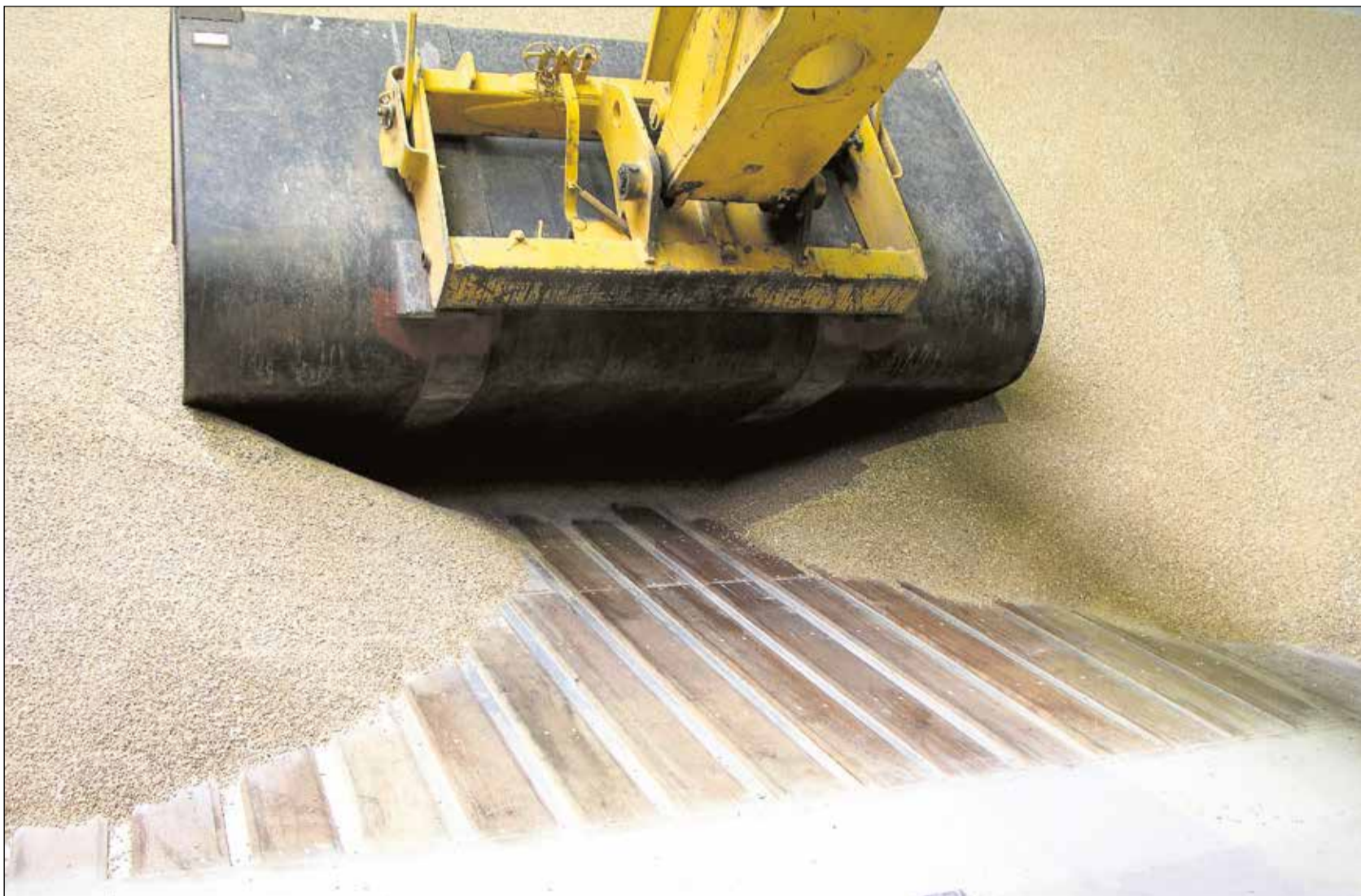
Tørreluften reguleres individuelt med 40 centimeters mellemrum, og der er højst seks centimeters afstand imellem kanalerne. Det er »bare« træ, men slidstyrken er uovertruffen, og Dan-Corn yder ti års garanti. (Foto: Dan-Corn)
